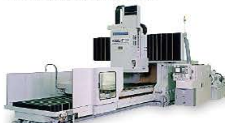
超大型研磨機 ( 3,000\text{mm} \times 6,000\text{mm} 対応)
